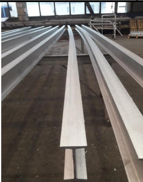
Wytrącone aluminium – kożuch – nie są usuwane
