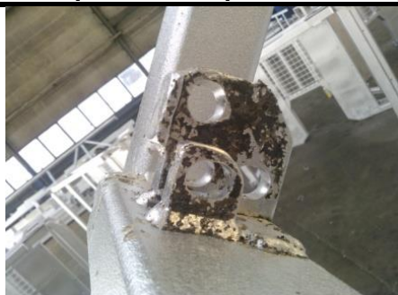
Zanieczyszczenia stali, ślady po naklejkach powodujące niedocynkowania – pozostają niezaprawione
