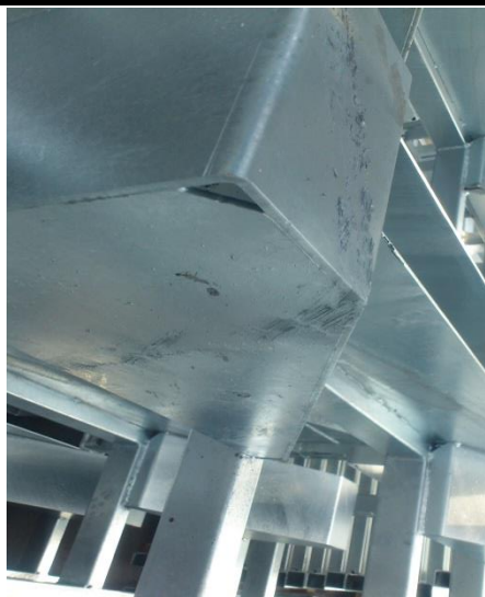
Miejsca po zawiesiach (drutach), ślady po popiele – nie są zaprawiane
