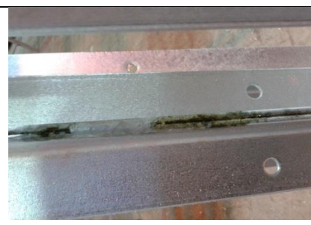
Nieszczelne spawy – wydmuchy i wycieki nie są zaprawiane
