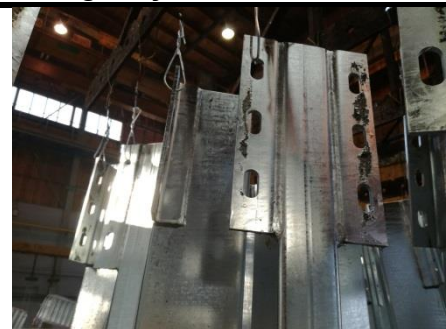
Zanieczyszczenia stali, ślady po naklejkach powodujące niedocynkowania – pozostają niezaprawione
