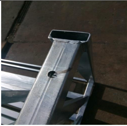
Miejsca po zawiesiach (drutach), ślady po popiele – nie są zaprawiane
