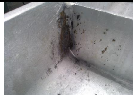
Sople i nawisy cynku (firanki) – miejsca spływu cynku
