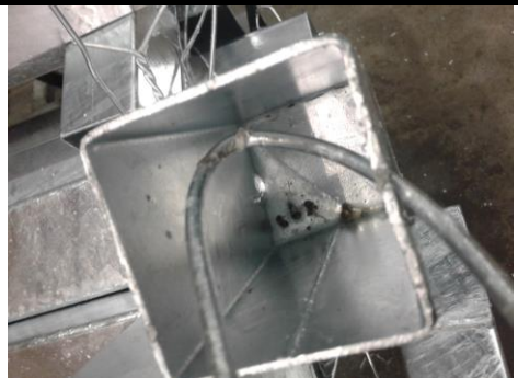
Niewłaściwie przygotowane otwory powodują pozostawienie nadlewów cynku, liczne niedocynkowania (materiał nie zanurzy się w piecu, zapowietrzy się) oraz niebezpieczne dla pracowników cynkowni rozerwania profili.
