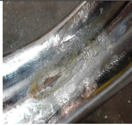
Miejsca po zawiesiach (drutach), ślady po popiele – nie są zaprawiane
