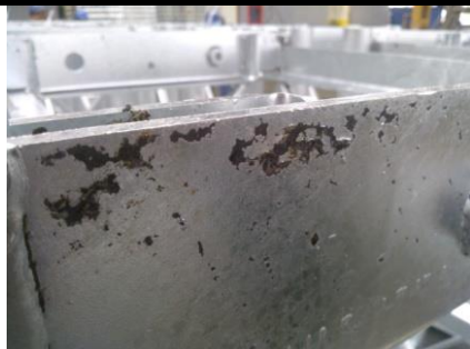
Miejsca nieocynkowane wynikające z przyczyn wad konstrukcji np. nieszczelne łączenia spawane, nieprawidłowo wykonane otwory, gatunku stali o składzie niezgodnym z WTO
