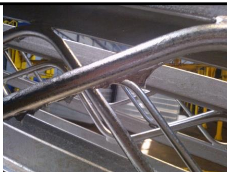
Sople i nawisy cynku (firanki) – miejsca spływu cynku
