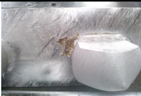
Sople i nawisy cynku (firanki) – miejsca spływu cynku
