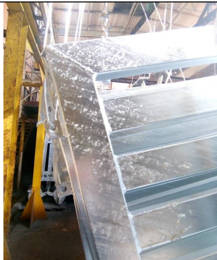
Chropowata struktura powierzchni zgodna z normą.
