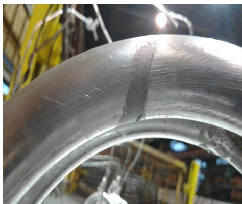
Naprawiana powłoka zgodnie z punktem 5 WTO
