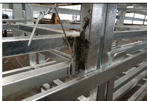
Nieszczelne spawy – wydmuchy i wycieki nie są zaprawiane
