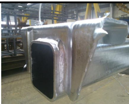
Sople i nawisy cynku (firanki) – miejsca spływu cynku
