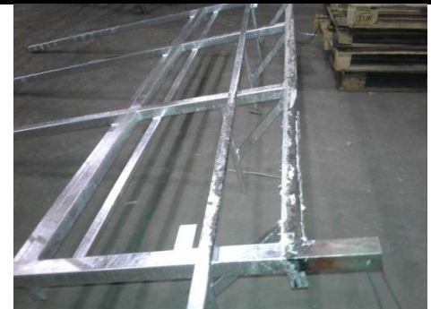
Niewłaściwie przygotowane otwory powodują pozostawienie nadlewów cynku, liczne niedocynkowania (materiał nie zanurzy się w piecu, zapowietrzy się) oraz niebezpieczne dla pracowników cynkowni rozerwania profili.
