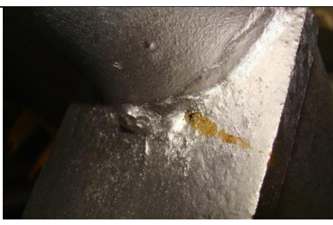
Nieszczelne spawy – wydmuchy i wycieki nie są zaprawiane
