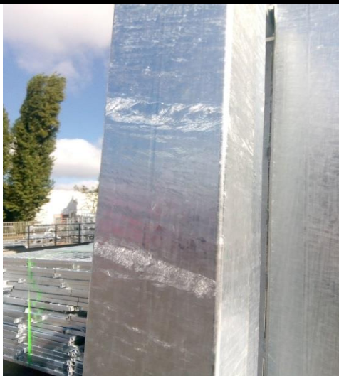
Wytrącone aluminium – kożuch – nie są usuwane
