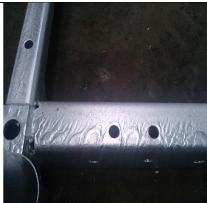
Struktura powłoki wynikająca z gatunku stali
