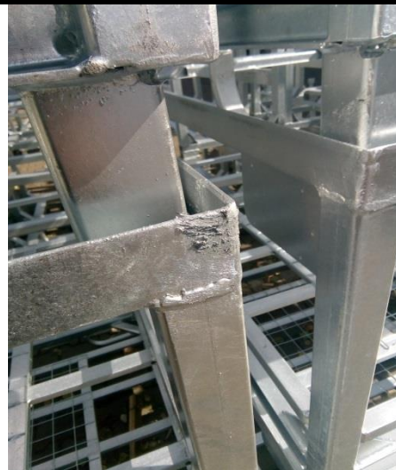
Miejsca po zawiesiach (drutach), ślady po popiele – nie są zaprawiane
