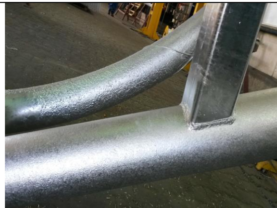
Struktura powłoki wynikająca z gatunku stali
