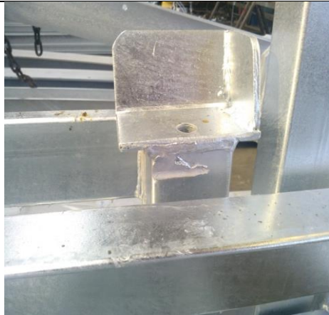
Miejsca po zawiesiach (drutach), ślady po popiele – nie są zaprawiane
