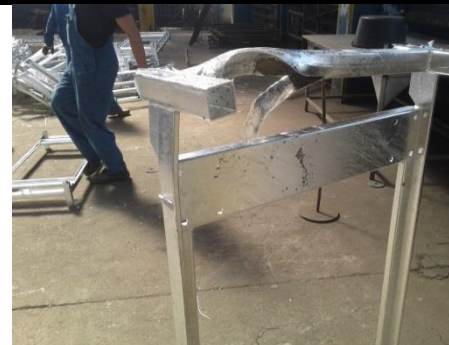
Niewłaściwie przygotowane otwory powodują pozostawienie nadlewów cynku, liczne niedocynkowania (materiał nie zanurzy się w piecu, zapowietrzy się) oraz niebezpieczne dla pracowników cynkowni rozerwania profili.
