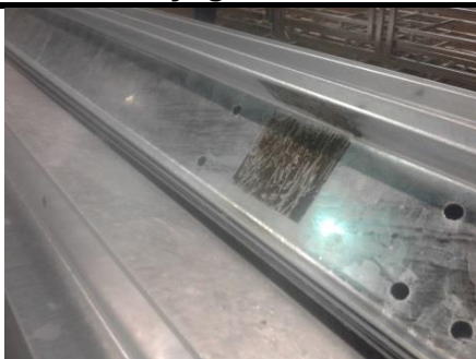
Zanieczyszczenia stali, ślady po naklejkach powodujące niedocynkowania – pozostają niezaprawione
