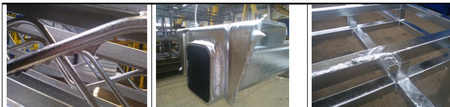
Sople i nawisy cynku (firanki) – miejsca splywu cynku
