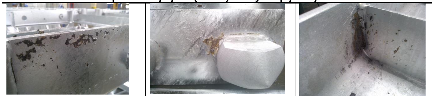
Sople i nawisy cynku (firanki) – miejsca splywu cynku
