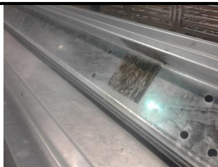
Zanieczyszczenia stali, ślady po naklejkach powodujące niedocynkowania – pozostają niezaprawione
