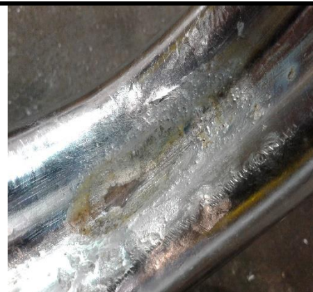
Zanieczyszczenia stali, ślady po naklejkach powodujące niedocynkowania – pozostają niezaprawione
