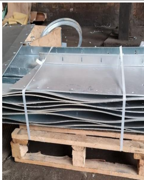
Pokud se v předmětu vyskytuje vlastní pnutí, může po zahřátí v zinkové lázni na teplotu 450 °C dojít k jeho deformaci. Díly z plechu nebo plechy, které jsou součástí větších předmětů, se mohou zvlnit.
