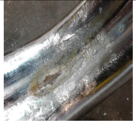
Znečištění oceli, stopy po nálepkách způsobují nepozinkovaná místa – neopravují se
