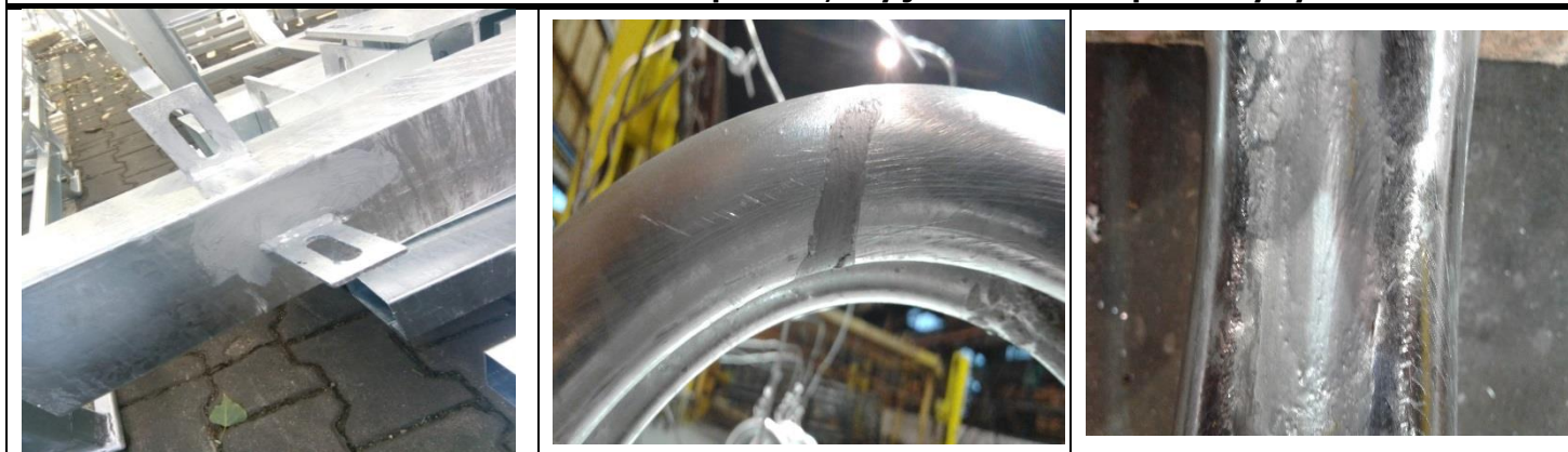
Opravovaný povlak v souladu s bodem 5 TPP
