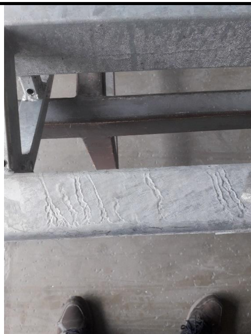
U profilů ohýbaných za studena se mohou vyskytnout tlustší pruhy zinkového povlaku,
