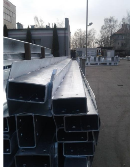
Pokud se v předmětu vyskytuje vlastní pnutí, může po zahřátí v zinkové lázni na teplotu 450 °C dojít k jeho deformaci. Díly z plechu nebo plechy, které jsou součástí větších předmětů, se mohou zvlnit.
