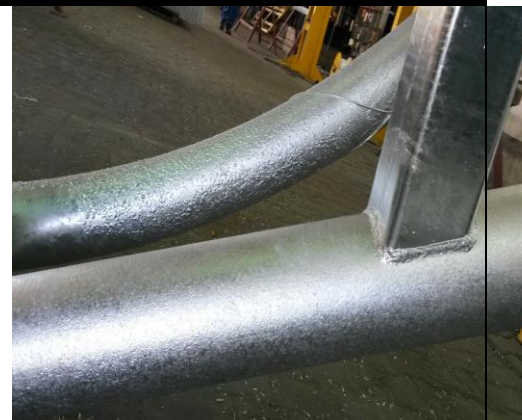
V důsledku nehomogenity vnějšího povrchu zinkovaného předmětu (chemické složení, struktura povrchu a jiné) se zinkový povlak vypadat na jednom předmětu rozdílně.
