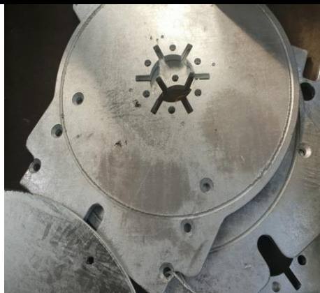
V důsledku nehomogenity vnějšího povrchu zinkovaného předmětu (chemické složení, struktura povrchu a jiné) se zinkový povlak vypadat na jednom předmětu rozdílně.
