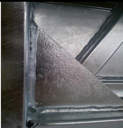
V důsledku nehomogenity vnějšího povrchu zinkovaného předmětu (chemické složení, struktura povrchu a jiné) se zinkový povlak vypadat na jednom předmětu rozdílně.
