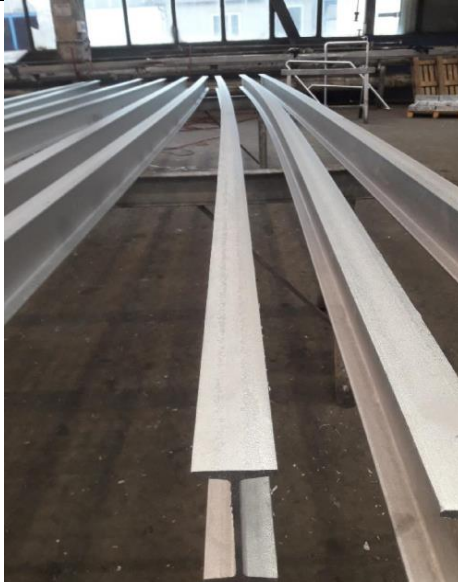
Pokud se v předmětu vyskytuje vlastní pnutí, může po zahřátí v zinkové lázni na teplotu 450 °C dojít k jeho deformaci. Díly z plechu nebo plechy, které jsou součástí větších předmětů, se mohou zvlnit.
