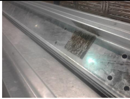
Znečištění oceli, stopy po nálepkách způsobují nepozinkovaná místa – neopravují se
