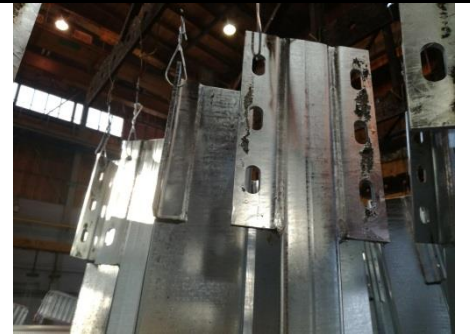
Znečištění oceli, stopy po nálepkách způsobují nepozinkovaná místa – neopravují se
