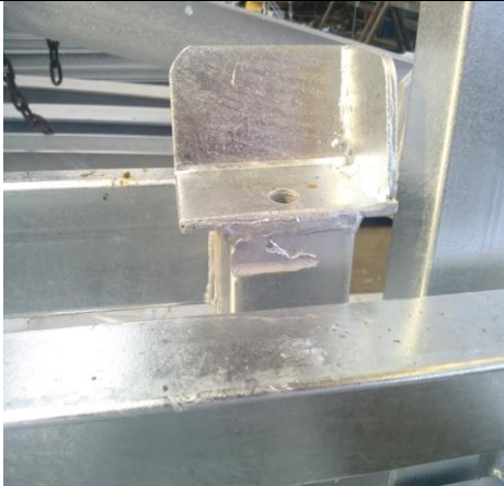
Místa po věšácích (drátech), stopy po popelu – neopravují se
