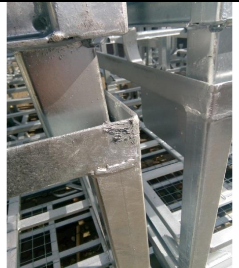
Místa po věšácích (drátech), stopy po popelu – neopravují se
