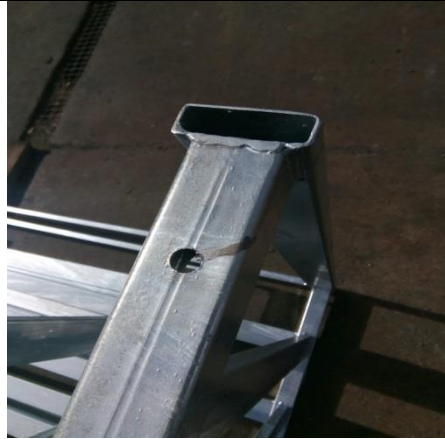
Místa po věšácích (drátech), stopy po popelu – neopravují se
