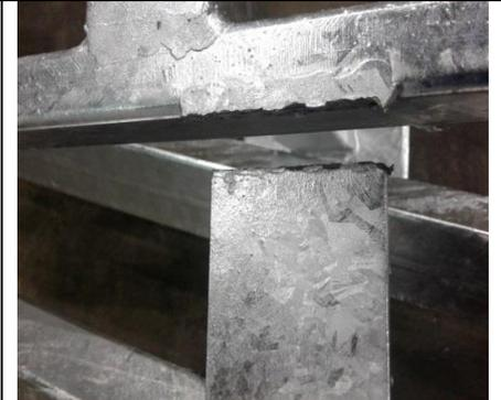
Bei diskontinuierlich geschweißten oder punktgeschweißten Elementen sind Leckagen von Flussmittelrückständen oder Zinkasche möglich, die dunkle Schlieren auf dem Zinküberzug an den Verbindungsstellen verursachen.
