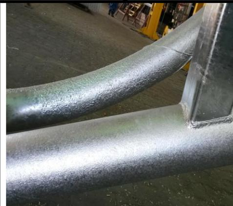
**Aufgrund der Inhomogenität der äußeren Oberfläche des verzinkten Gegenstands (chemische Zusammensetzung, Oberflächenstruktur u.a.) kann der Zinküberzug auf ein und demselben Objekt unterschiedlich geformt sein und unterschiedlich aussehen.**
