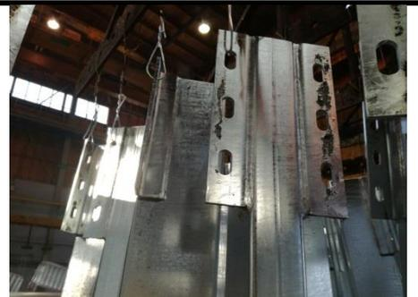
**Verunreinigungen von Stahl, Spuren von Aufklebern, die zu einer Unterverzinkung führen - bleiben unbehandelt**
