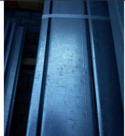
**Unregelmäßigkeiten in der Oberfläche des Grundwerkstoffs, z. B. Grubenbildung, verursacht durch Walzschlacken, Rillen, Hohlräume in der Schweißnaht, Lochfraß, Lämpungen oder Delaminationen können sichtbar bleiben oder nach dem Feuerverzinkungsprozess sichtbar werden.**
