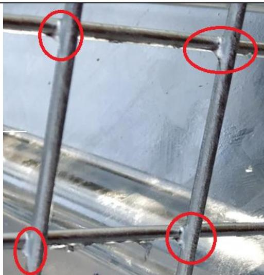
**In den Ecken von Drahtverbindungen in Maschenkonstruktionen können leichte Überschwemmungen zurückbleiben. Es wird empfohlen, sie zu belassen - ihre Entfernung kann zu einer Unterbrechung der Beschichtung führen.**
