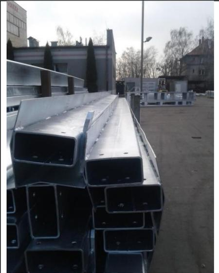
Bei Eigenspannungen in der Konstruktion kann es infolge von Erhitzung im Zinkbad auf bis zu 450°C zur Verformung der Produktform kommen. Blechelemente oder Bleche, die Teil einer größeren Konstruktion sind, können sich wellen.
