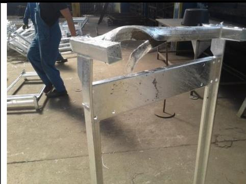
Unsachgemäß vorbereitete Löcher verursachen Speiser, zahlreiche unterverzinkte Stellen (das Material wird nicht in den Ofen getaucht, es kommt zu Luftpneinschlüssen) und Profilrisse, die für die Mitarbeiter des Verzinkungsbetriebs eine Gefahr darstellen.
