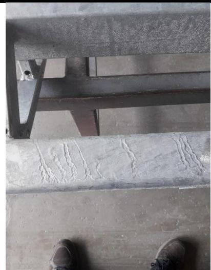
**Bei kaltgeformten Profilen kann es zu streifenförmigen Verdickungen vom Zinküberzug kommen, die jedoch die Korrosionsschutzeigenschaften der Beschichtung nicht beeinträchtigen.**
