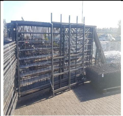
Das an den Verzinkungsbetrieb gelieferte Material muss ordnungsgemäß verpackt sein. Material ohne Paletten oder Ständer kann ggf. bei der Entladung, der Beladung und dem internen Transport beschädigt werden
