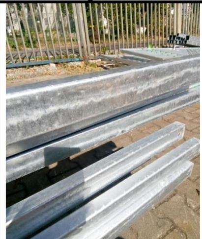
Weiße Korrosion auf der Beschichtung ist kein Reklamationsgrund, solange die erforderliche Mindestdicke der Zinkschicht eingehalten wird.
