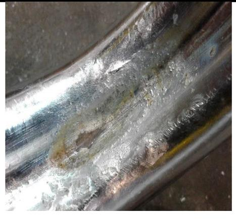
**Stellen, an denen Anhängervorrichtungen (Drähte) angebracht waren, Spuren von Asche - werden nicht behandelt**
